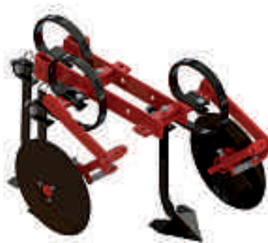
Élément bineur complet CHOPSTAR 25-59 cm avec disques de protection et dents à pattes d'oies
