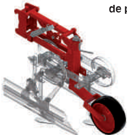
Élément bineur avec parallélogramme sur bineuse frontale (uniquement sur CHOPSTAR)
