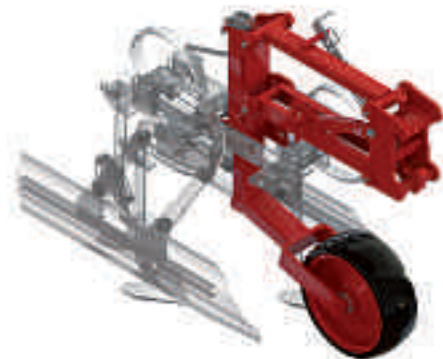
Élément bineur avec parallélogramme sur bineuse arrière
