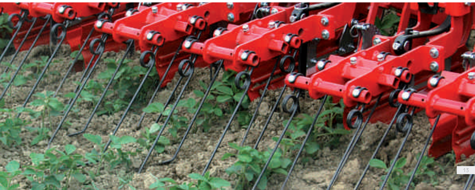
Élément bineur complet CHOPSTAR 25-59 cm avec tôles de protection et dents à pattes d'oies
