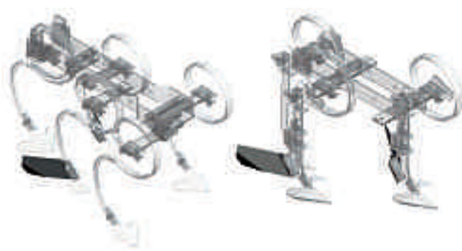
Avec des socs butteurs on peut butter la culture. Ils se montent aussi bien sur les dents en S ou à pattes d'oies réglable en hauteur.
