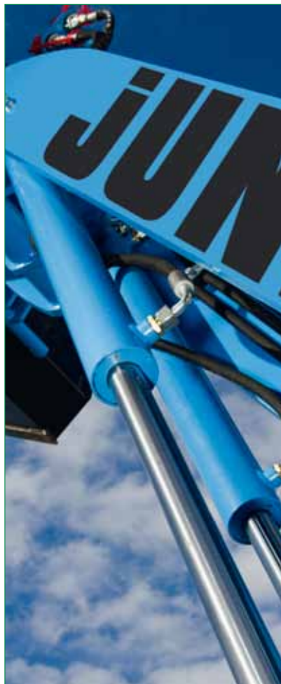
Die beiden innenliegenden Hubzylinder sorgen für extreme Stabilität in der Schwinde und es werden große Hubkräfte erreicht.
