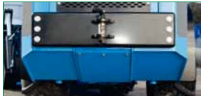
Abschleppvorrichtung und Motorölschutzwanne serienmäßig
