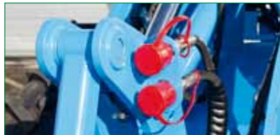
doppelt wirkende Hydraulikanschlüsse vorne serienmäßig
