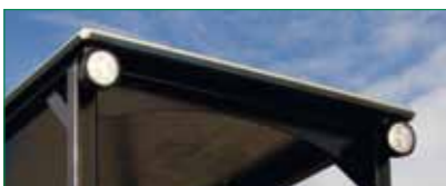
LED-Arbeitsscheinwerfer mit Schutzart IP 9K
