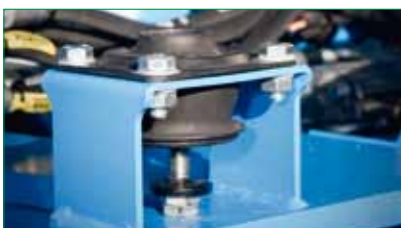
Die Kabinenlager reduzieren Vibrationen und steigern den Komfort
