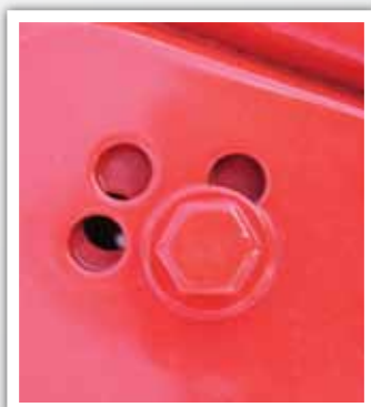
Système de réglage mécanique « PASSO » pour la largeur de travail des socs
