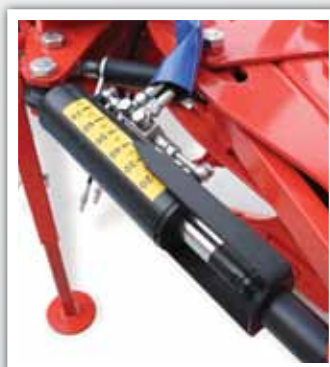
Système de réglage hydraulique « VARIO » pour la largeur de travail des socs
