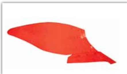
MP 4 WN Versoir de forme semi-hélicoïdale
