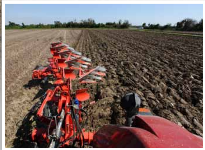
Réglage uniforme de la largeur de travail du premier corps.
