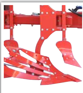
Système de sécurité à boulon de cisaillement de 10,9 Nm
