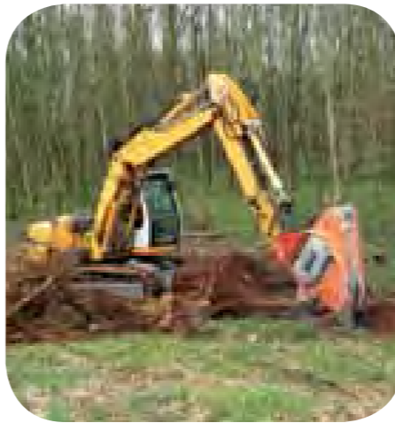
Woodcracker R – schonende Entnahme des Wurzelstockes und sofortige Zerkleinerung schafft wertvolle Biomasse.
