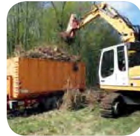
Woodcracker R – schonende Entnahme des Wurzelstockes und sofortige Zerkleinerung schafft wertvolle Biomasse.
