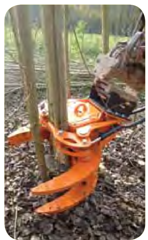
Woodcracker C 150: Starrer Anbau (z.B. am Bagger)
