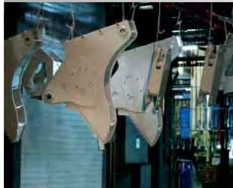
Modernste Beschichtungstechnik garantiert höchsten Qualitätsstandard: Mittels 6-stufigem KTL-Grundierungs- und Pulverbeschichtungsverfahren wird eine strapazierfähige Oberflächenbeschaffenheit gewährleistet, wie sie sonst nur in der Automobilindustrie vorzufinden ist.
