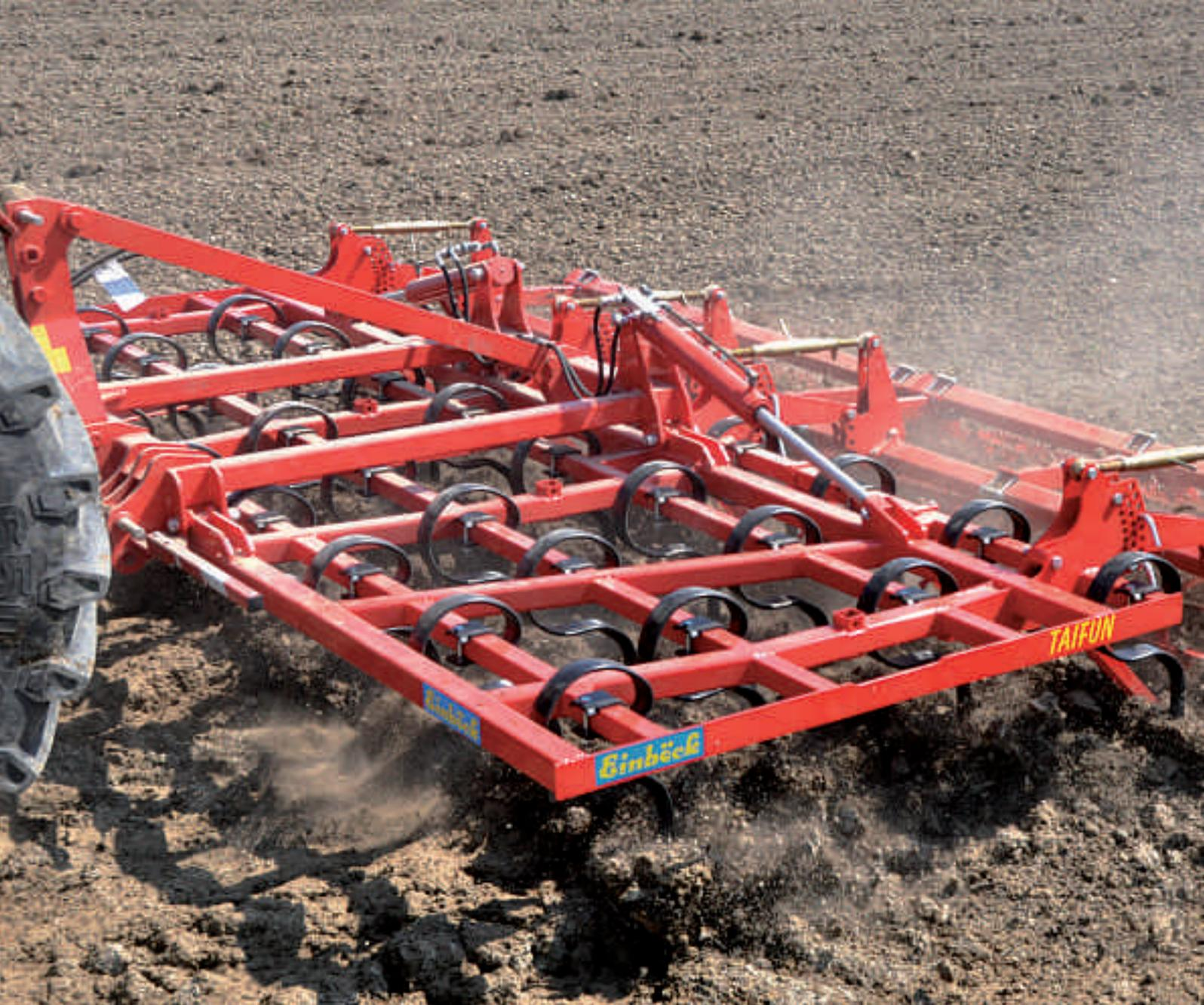
Die **Arbeitstiefe** der Arbeitswerkzeuge wird beim TAIFUN über den Oberlenker und die Nachlaufwalze eingestellt. Es wird der gesamte Druck auf die Nachlaufwalze gebracht, wodurch ein sehr ruhiges Arbeiten der Maschine erreicht wird.
