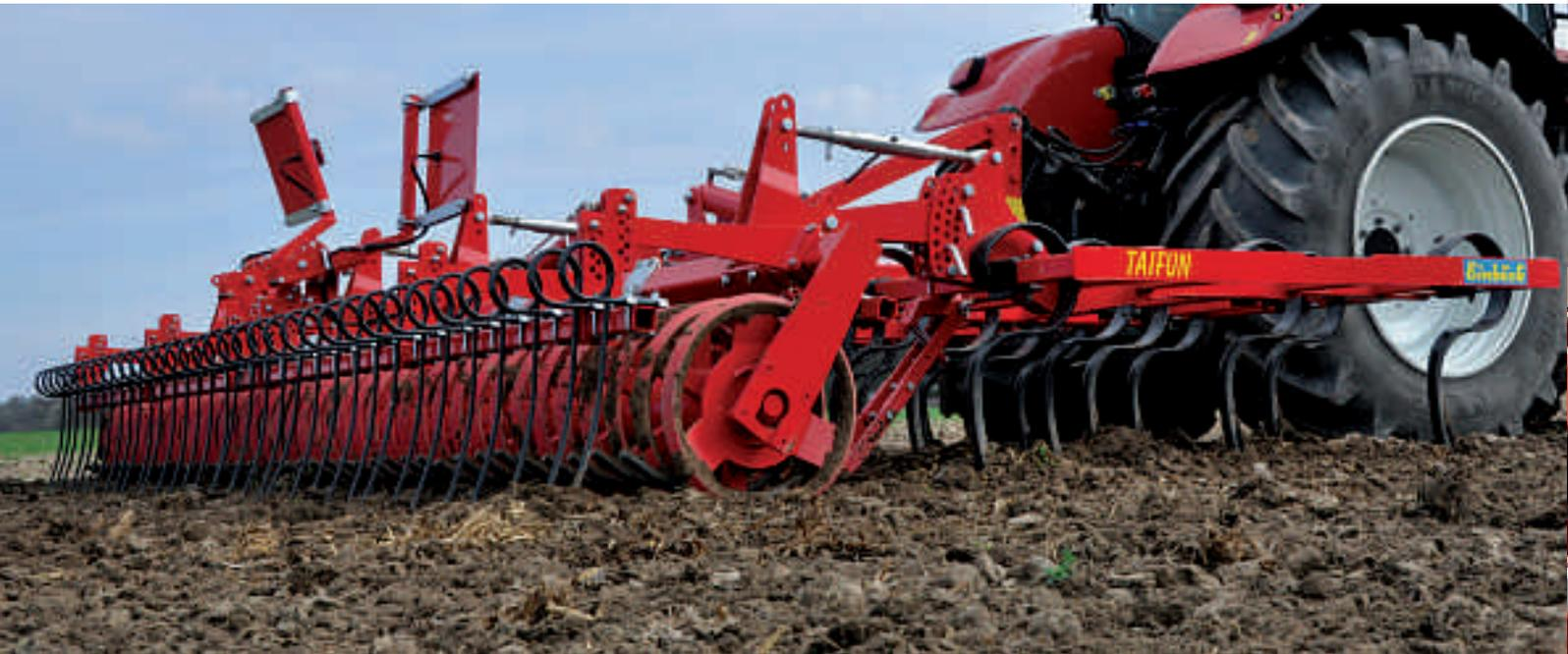
Die bereits bekannten Nachlaufwalzen sind im Halblochraster parallel höhenverstellbar. Um eine souveräne Bodenbearbeitung zu erzielen, sind zwischen der letzten Zinkenreihe und den diversen Nachlaufgeräten einzelne gefederte Doppelschleppzinken montiert, die für eine exakte Einebnung sorgen.
