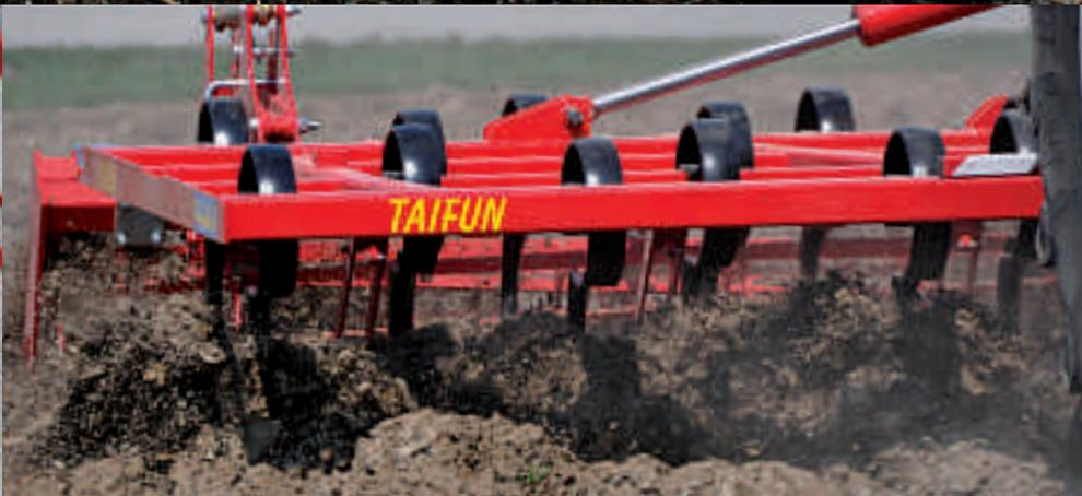
Wenn der TAIFUN für die Saatbettbereitung im Einsatz ist, sind **verstellbare federbelastbare Doppelschleppzinken** montiert. Unebenheiten, die durch die letzte Zinkenreihe entstehen, werden noch vor den Nachlaufwalzen eingeebnet. Das ist sehr wichtig, weil die nachfolgende Walzeinheit den Boden über die gesamte Breite gleichmäßig rückverfestigt. Bei viel organischer Masse, wie z.B. Stroh, können die Doppelschleppzinken schnell und werkzeuglos entfernt und in die Parkposition gehängt werden.
