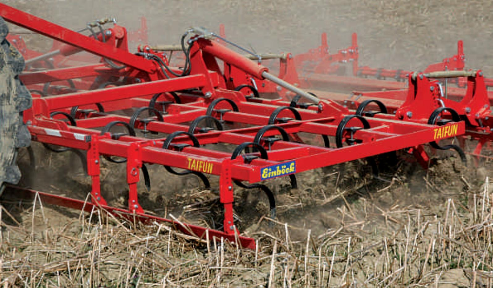
Das **Planierschild** wird vorne am Rahmen festgeklemmt und ist mittels Bolzen höhenverstellbar. Durch die eingebaute **Verstellmöglichkeit („schleppend“ oder auf „Griff“)** zerdrückt es die Schollen, ebnet den Boden ein und deckt die Traktorspur ab. Es werden die Arbeitswerkzeuge sehr ruhig geführt und die Arbeitstiefe genauer eingehalten. Speziell zur Saatbettbereitung im Frühjahr ist das Planierschild empfehlenswert.
