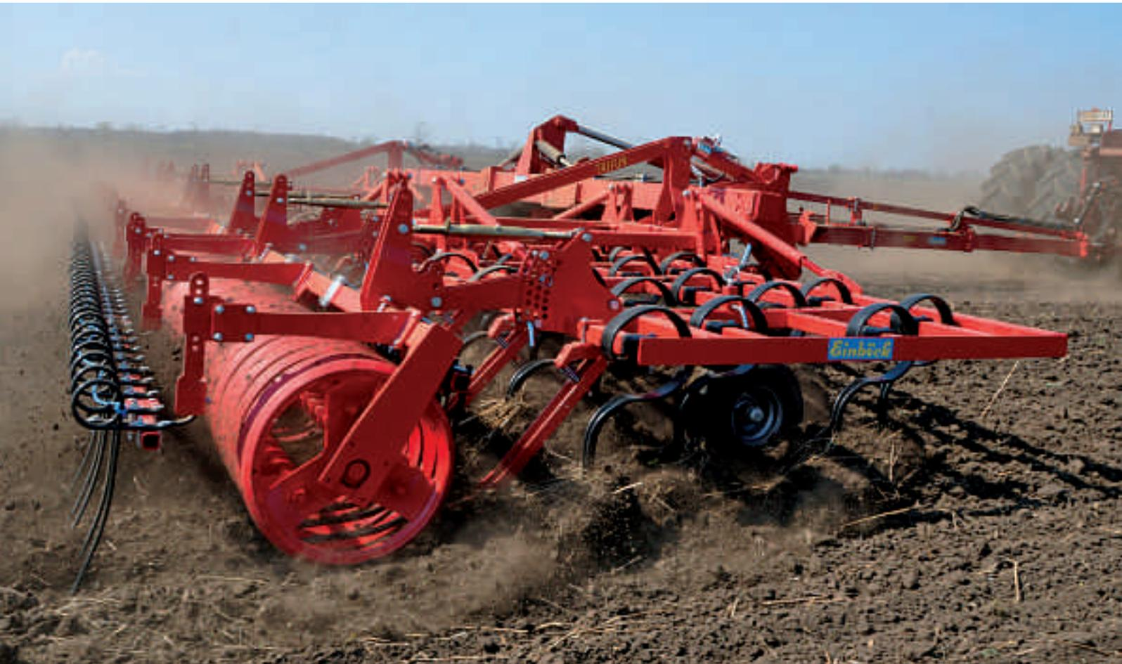
Für Betriebe, die auch kleinere Zugmaschinen auslasten wollen, ist es möglich, die Geräte vom Systemträger zu trennen und sie als vollwertige Dreipunktgeräte zu verwenden.
