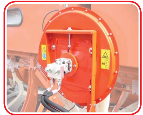
Hydraulisch betriebenes Gebläse • Accionamiento hidráulico de la turbina • Accionamiento hidráulico do compressor
