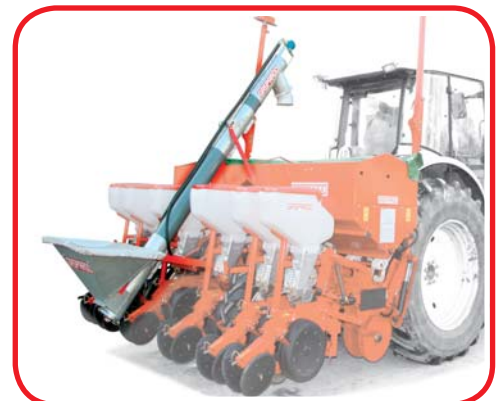
Befüllschnecke Düngemittel • Sinfin de carga de abono • Parafuso sem fim de carga de adubo
