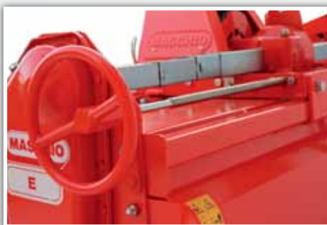
Detail des mechanischen Systems zur Seitenverschiebung mit Schraube und Kurbel des Modells "E"
