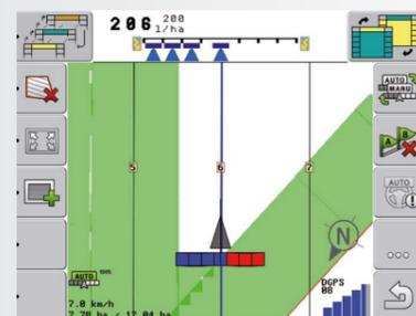
Cette application permet de mettre en marche et d'arrêter des machines, des parties de machines ou des buses individuelles par commande GPS. SECTION-Control peut contrôler jusqu'à 72 tronçons de rampe ou buses individuelles. L'application est conforme à la norme ISOBUS..
