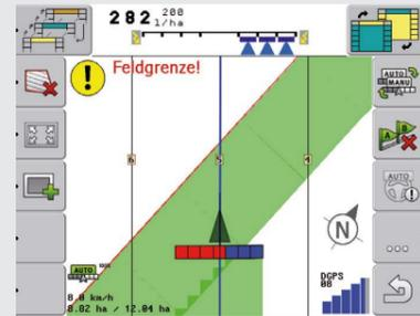
Cette application vous permet de faire des passages parallèles en mode A/B, A+, Multi A-B, en cercle, en bout de champ ou en contour, même en cas de mauvaise visibilité, en combinaison avec un récepteur D-GPS. En outre, les obstacles peuvent être marqués et stockés avec des données de terrain, telles que les limites et les pistes. Les opérations interrompues peuvent être sauvées et poursuivies à tout moment.
